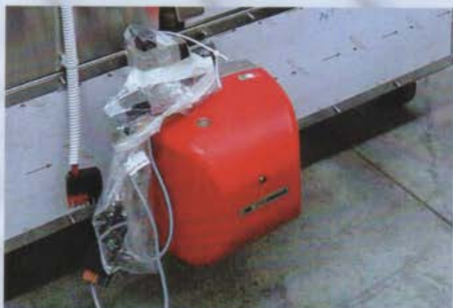
Bruciatore ad aria soffiata (marca UNIGIG, ditta leader italiana per la fabbrica di bruciatori anche per altre marche) montato sul retro del forno. Camera di combustione stagna. Dotazione, 1 bruciatore per forno singolo e doppio, 2 bruciatori per forno MAXI.
